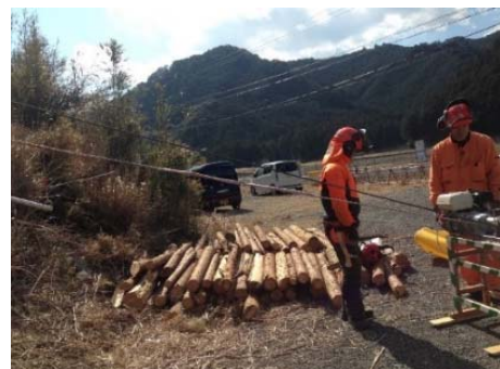
「マッシュプーリー」を使用した簡易架線およびPCウィンチによる集材・搬出作業の様子
