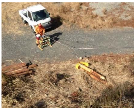
「マッシュプーリー」を使用した簡易架線およびPCウィンチによる集材・搬出作業の様子
