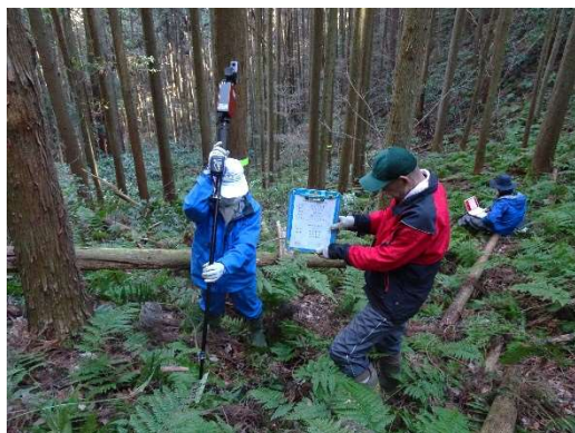
地上レーザーによる林分調査(那珂川町)
