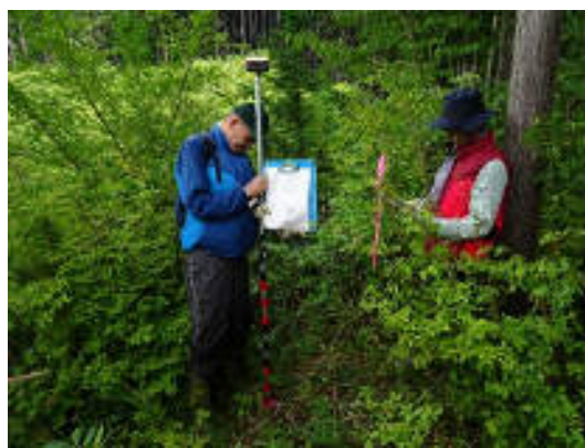
D-GNSSによる境界測量(大田原市)
