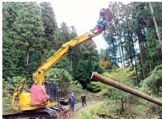
伐倒・搬出作業（スイングヤーダ）
